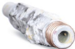
Störungen der Maschinen durch hohen Partikelanteil im Wasser
